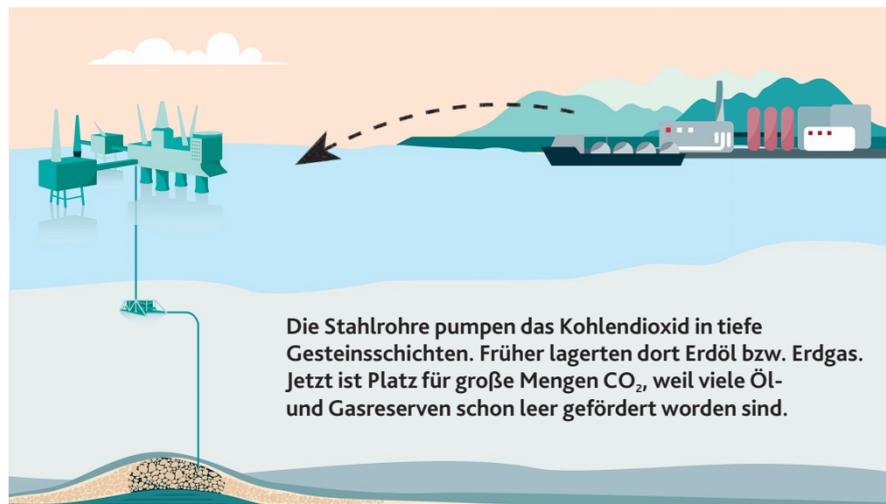
Die Stahlrohre pumpen das Kohlendioxid in tiefe Gesteinsschichten. Früher lagerten dort Erdöl bzw. Erdgas. Jetzt ist Platz für große Mengen CO<sub>2</sub>, weil viele Öl- und Gasreserven schon leer gefördert worden sind.
